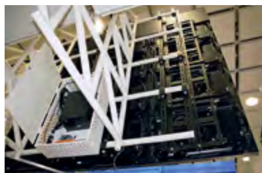
Der Industrie-PC Magnius-I von InoNet steuert – für die Passagiere unsichtbar – die zwölf zur Videowand gruppierten Displays.
